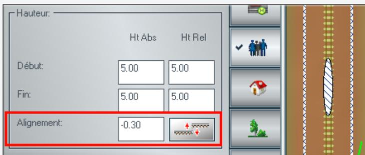
*Utilisation du facteur d'alignement pour régler la différence de hauteur entre la voie et la surface*
